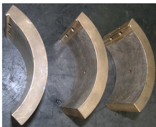
Рисунок 6 – Бронзовые колодки с комбинированным антифрикционным покрытием
